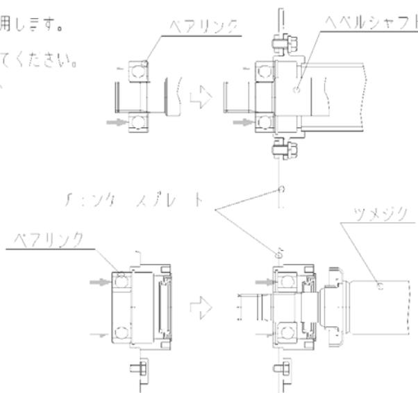
**\* ベベルシャフトをベベルギヤに挿入しスプラインが入ってからキャリアを留めているボルトを締めて下さい。
