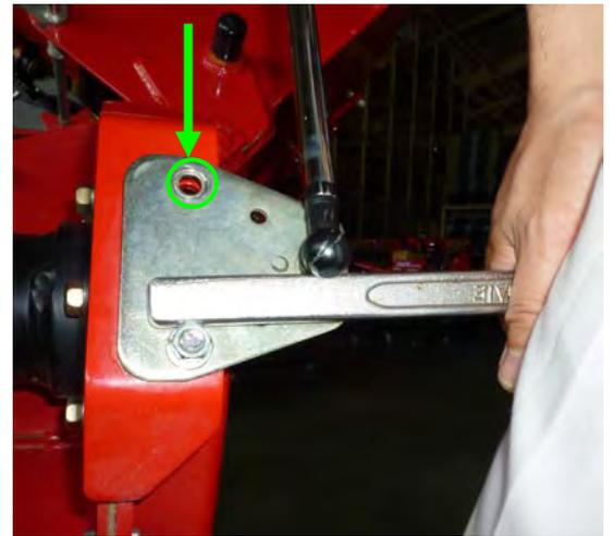
3. この時点でガスプリングの力は作業機に働いていないので、注意して作業機を折りたたみの状態に戻す。
