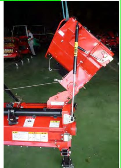
ロッドブラケット取り付けボルトを2本共緩め、ボルト穴位置をシなどで調整し、上側のボルトを先に外す。
