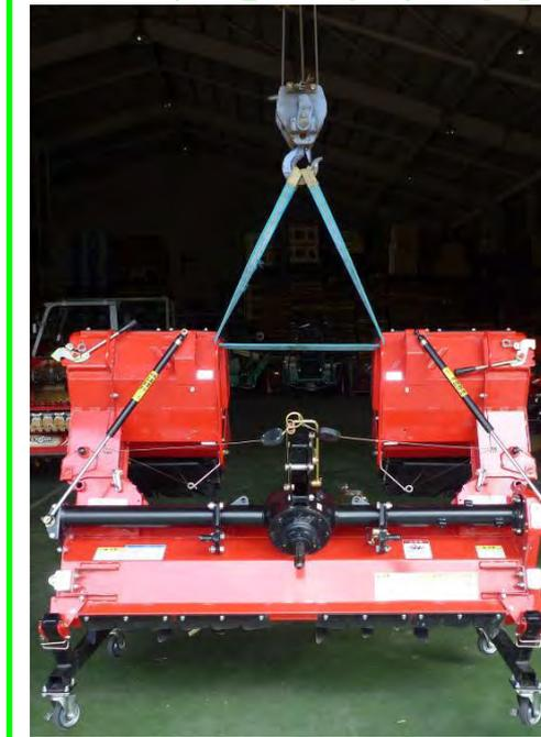
1. 爪軸台（油圧ジャッキ）で爪軸を受ける。
