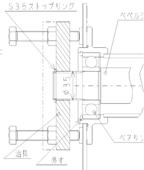
**\* フレームトップからベベルシャフトとベアリングを抜く前には、キャリアを留めているボルトを緩めないで下さい。ベベルシャフトとベベルギヤのスプラインがこぼれて抜けなくなります。**
