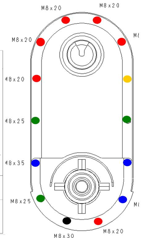
3. 14本のボルトを締め上げるときに、チェンカバー位置を樹脂ハンマでたたいて調整し、芯出し治具が手の力で動くようにしておく。
