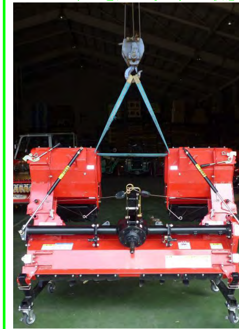
TXシリーズをクレーン等で吊った状態
