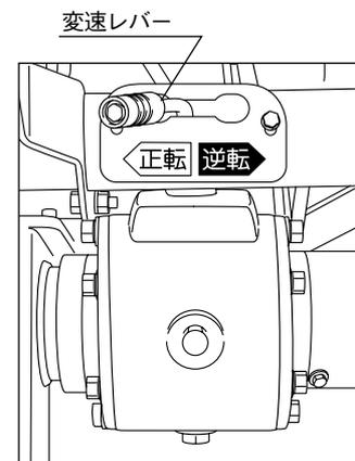
本機の爪軸は正転方向に取付けて出荷しております。
