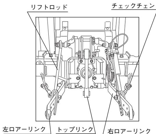
取付位置は、本書のトラクタ別装着表 (P29～32) を参照の上、トップリンク長さやリフトロッド位置を確認、取付けてください。
