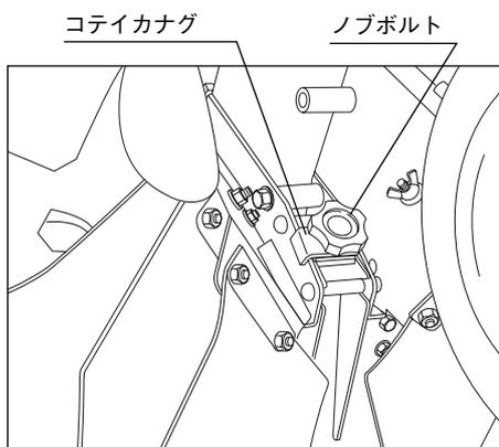
6. 土入れ爪軸にしっかりと爪を締め付けて爪軸をチェーンケースに取付けます。
