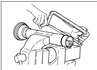
2. 切りとったセフティカバーと同じ長さでチューブをオス、メス両方切断します。
