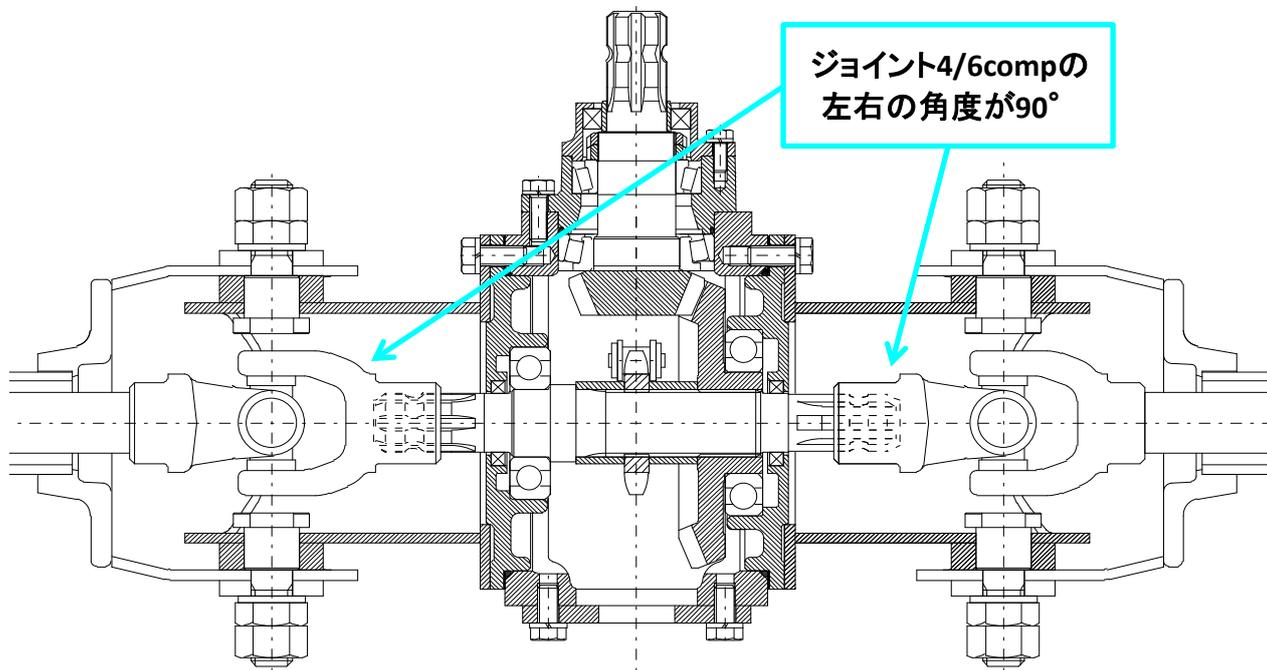
参考 ; 爪軸の組み付けは、後ろから見て右の爪軸が60° 先行するように組み付けて下さい。
