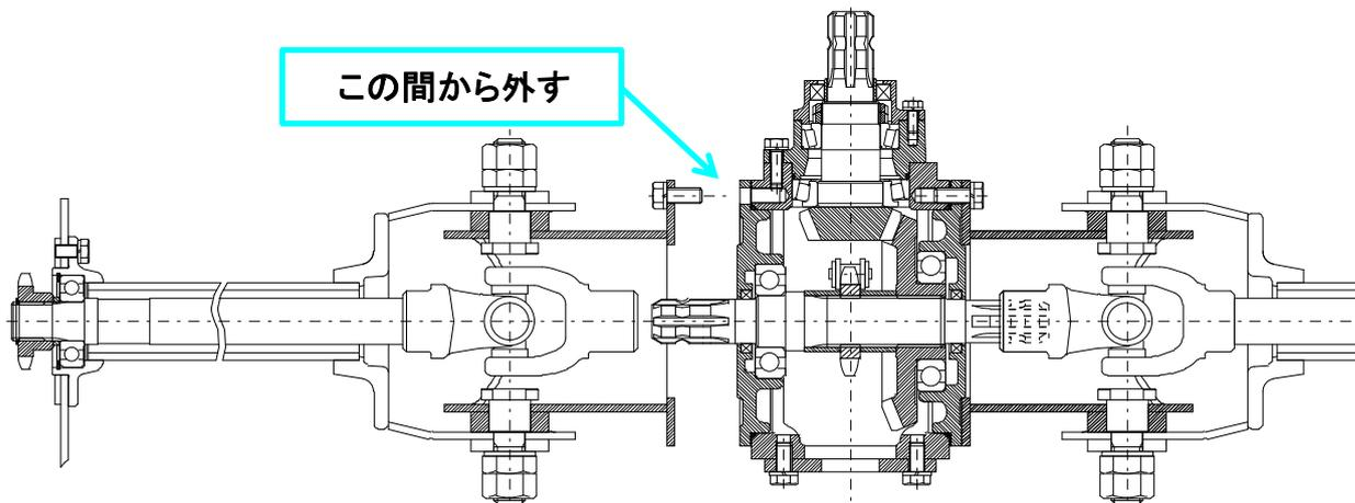
2. チェンケース側を分解し、ジョイント4/6compを取り外して下さい。
