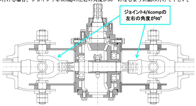
参考; 爪軸の組み付けは、後ろから見て右の爪軸が60° 先行するように組み付けて下さい。
