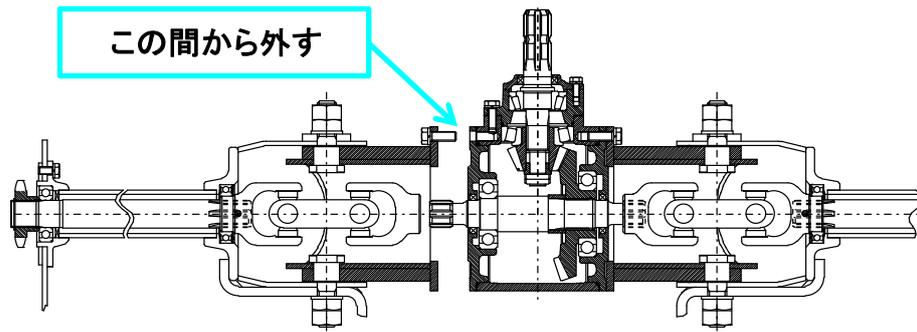
2. チェンケース側を分解し、サードシャフトとジョイントBをASSYで取り外して下さい。
