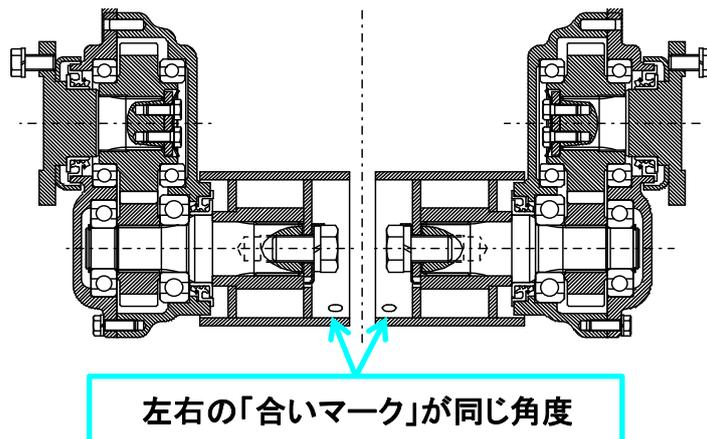
参考2 ; ギアボックスの組み立ては、ディスク軸を取付けるギアフランジ側 (ギアボックスL/R) に全て組み付けてから、ギアカバーL/Rで蓋をする。
