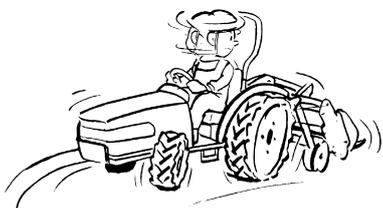
7-8 作業機は左右がトラクタの機体幅より広いため、走行時は十分注意してください。移動時は作業機の折りたたむ箇所は折りたたみ走行してください。又スタンドがついている場合も必ず外してください。
