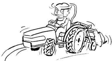
7-8 作業機は左右がトラクタの機体幅より広い場合、走行時は十分注意してください。移動時は作業機の折りたたむ箇所は折りたたみ走行してください。又スタンドがついている場合も必ず外してください。
