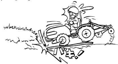
8-3 うねや段差に対して斜め方向に進むと、横滑りや転倒する危険があります。作業機を低くして重心を下げ、直角に進めてください。
