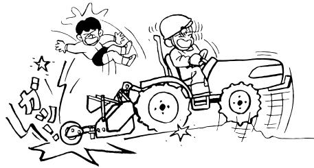
7-3 左右のブレーキペダルを連結して走行してください。
