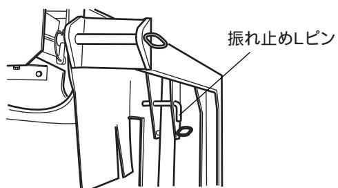
図の様に振れ止めをして移動してください。
