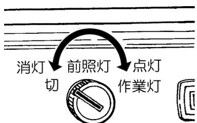
キースイッチ「入」でライトスイッチを右側に回すと前照灯が、さらに右側に回すと作業灯と前照灯が点灯します。
