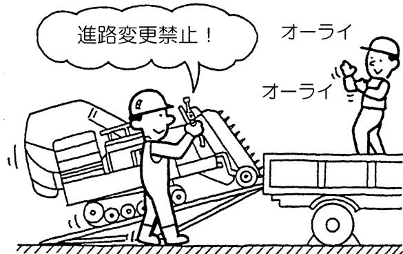
積込み・積降しは、下表の進行方向で行い、最低速（副变速を「低（作業）」位置にして、エンジン回転を「作業」位置（グリーンゾーン）まで上げ、主变速レバーをゆっくり倒して、「N」～「作業・2条」の位置）でゆっくり行ってください。積込み途中で本機が止まった場合は、主变速レバーをさらにゆっくり倒してください。
