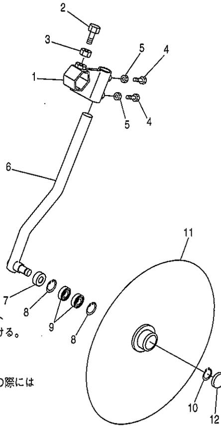
注1) 取付けは、左右のオイルブラケットを外し、フロントディスクを取付けた後、再度オイルブラケットを取付ける。そして、各部のボルト類を掘取作業しながら調整、締め付けを行う。
