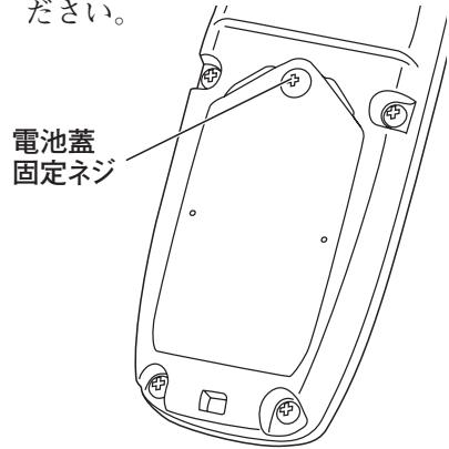
②電池蓋を図のように起こし、スライドさせ電池蓋を取り外します。
