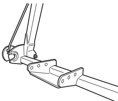
**2** トラクタのポジションコントロールレバーを下げる、ロアリンクをいっぱいまで下げます。
