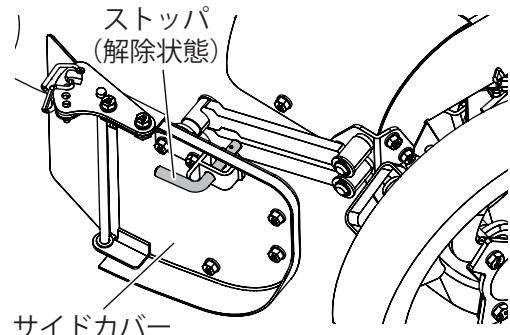
下図のような高畦作業を行うような場合はストッパロック状態にしサイドカバーを最上げにします。
