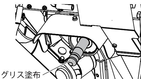
**5 作業機をトラクタに取付けます。**
