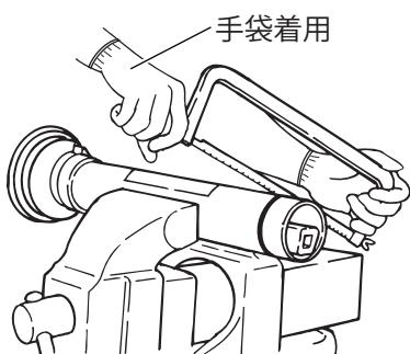
2 切りとったセーフティカバーと同じ長さで、チューブシャフトを金ノコまたはカッタで、オスとメス両方切断します。
