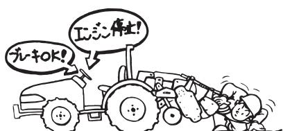
10-2 点検のために外した防護カバーは、必ず元の通りに取付けてください。
