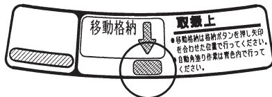
2. オフセットが格納位置まで動かない場合はドラム「右」ボタンでドラム旋回させた後、オフセット「内」ボタンで移動・格納位置ラベルの格納範囲まで移動させてください。その後、購入先に連絡してください。
