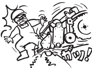
9-6 作業機のカバーは、土礫が飛散しないように調節してください。
