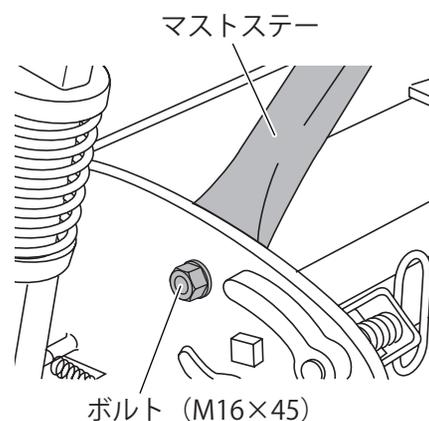
トップマスト、マストステー、ジョイントハンガをボルト（M16×140）で取付けます。
