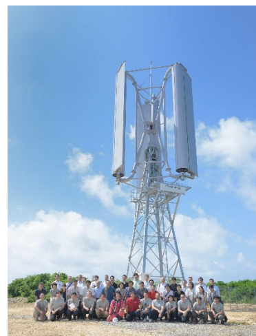
垂直軸型マグナス式風力発電機 (提供：チャレナジー株式会社)
