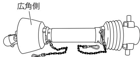
(1) ジョイントのノックピンを押しながら軸に挿入し、軸の溝にノックピンをはめ込み、抜け止めをします。
