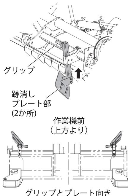
**2** トラクタに合わせて幅方向位置を変更します。それぞれの跡消しプレート部がタイヤの外側になるような位置で固定します。
