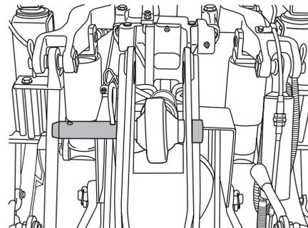
**4** 左右のロアリンクにオートヒッチアームのロアリンクピンを取付けます。
