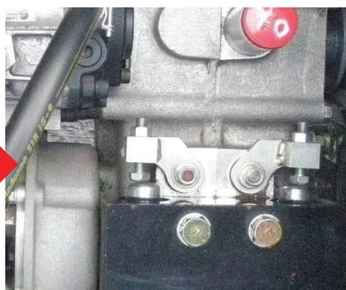
(2)クラッチシリンダのロッドが最縮の時にプッシュホルムが、クラッチシリンダのロッドに軽く触れるように調整します。
