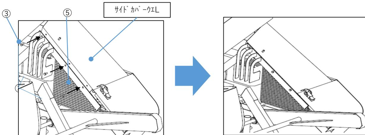
5. エンジンカバーMA【⑥】をサイドカバーウエルの溶接ボルトに通し、メインフレームにボルト固定してください。(カバー9と共縫い)
