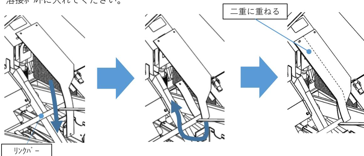
7. サイドガードゴムMA【④】をエンジンカバーMA【⑥】にナット固定してください。
