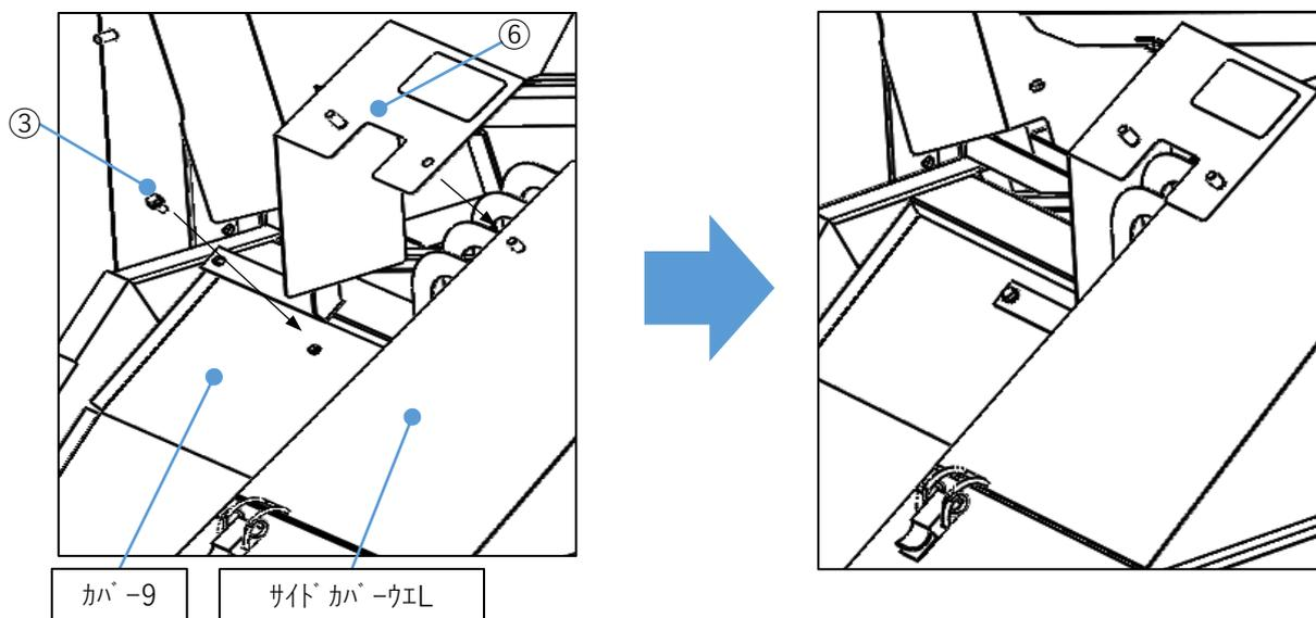
6. サイドガードゴムMA【④】をリンクバーに通し、エンジンカバーMA【⑥】とサイドカバーウエルの溶接ボルトに入れてください。
