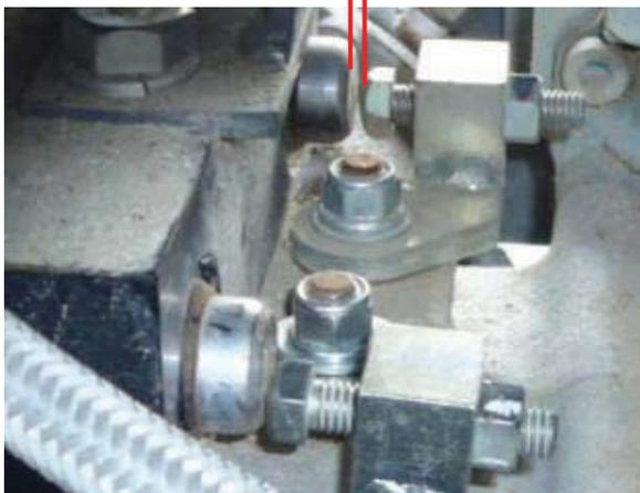
(3)クラッチシリンダのロッドが最伸びの時に、サイドクラッチアームL/Rに動き代が、わずかでも有る事を確認して下さい。(素手では固くて動かないので、19スパナ等で掴んで下さい。)
