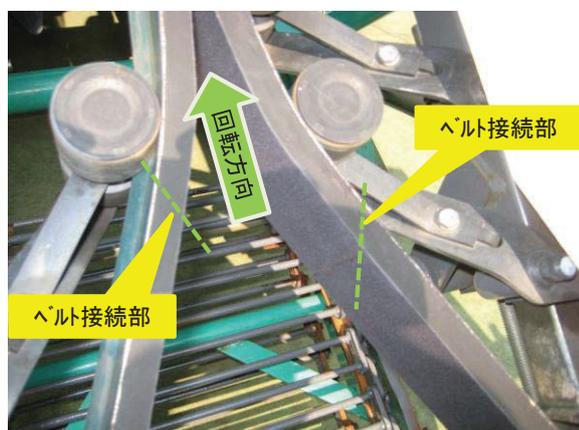
取付け不良の場合、ミッションが破損する恐れがあります。
