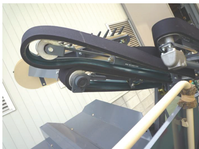
タシベルトが十分緩んだら取り外します。 (上側のタシベルト)
