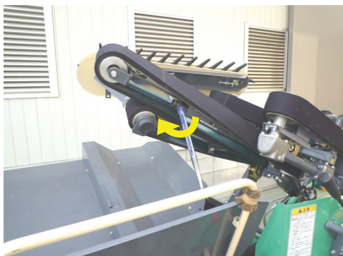
上側のテンションのナットをラチェットレンチ19などでゆるめます。 (右方向に回すと緩みます。)
