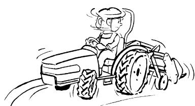
7-8 作業機は左右がトラクタの機体幅より広いため、走行時は十分注意してください。移動時は作業機の折りたためる箇所は折りたたみ走行してください。又スタンドがついている場合も必ず外してください。
