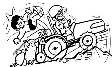
7-3 左右のブレーキペダルを連結して走行してください。
