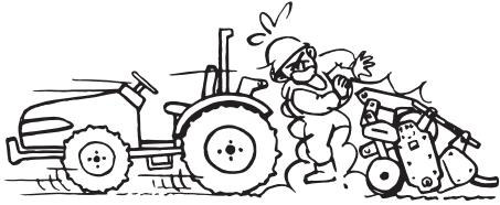
**3-3** トラクタと作業機の着脱に際しては、いつも逃げられる安全な態勢で操作し、このときトラクタは必ずブレーキで止めておいてください。
