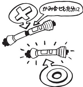
**3-6** 取付各部のトメピンが全て確実に装着されているか確認してください。
