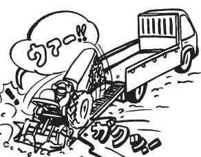
**6-6** 作業機をトラックで運搬する際は、折りたためる箇所は折りたたみ、作業機が動かないよう强度が十分あるロープ等で固定してください。
