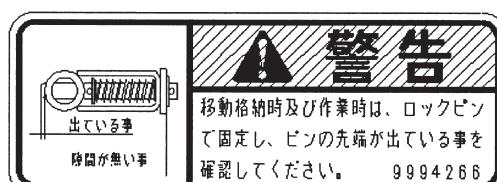
移動格納時及び作業時は、ロックピンで固定し、ピンの先端が出ている事を確認してください。
