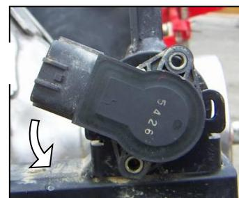
※センサを矢印と逆方向に回転させると破損します。
