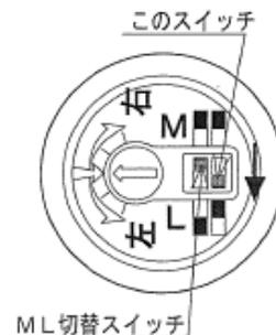
2) センシングセンサのマルコネジを2本緩め、センサを左右に軽く回転させ、センサ取付け座に馴染ませます。
