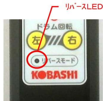
**リミットスイッチがスイッチプレートから離れるとリバーモードになり、リバーLEDが点滅します。この状態が正常です。**
