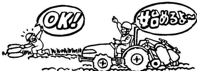
9-4 運転者が運転位置をはなれて作業機を調整する場合、又、爪軸等への草やワラのからみ付きを取りのぞく場合等は、必ずトラクターの駐車ブレーキをかけ、又、エンジンを停止し、かつ、PTO軸への動力の伝導が絶たれていることを確認した上で行ってください。
