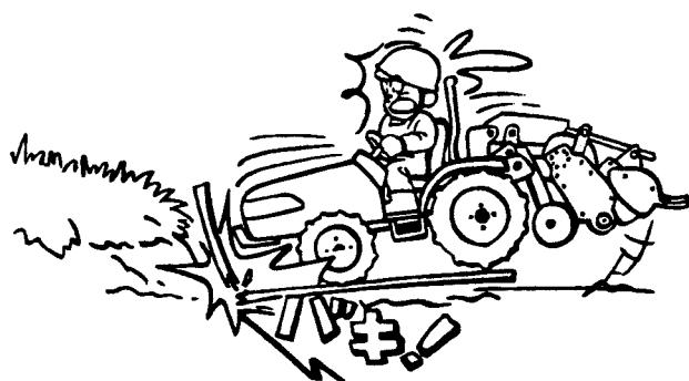
7-8 作業機は左右がトラクターの機体幅より広いため、走行時は十分注意してください。移動時は作業機の折りたためる箇所は折りたたみ走行してください。又、スタンドがついている場合も必ず外してください。
