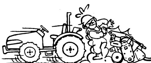
3-3 トラクターと作業機の着脱に際しては、いつも逃げられる安全な態勢で操作し、このときトラクターは必ずブレーキで止めておいてください。
