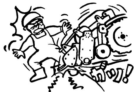
9-6 作業機のカバーは、土礫が飛散しないように調節してください。
