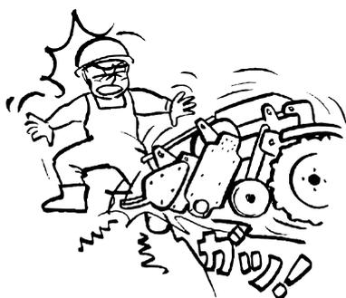
9-6 作業機のカバーは、土礫が飛散ないように調節してください。
