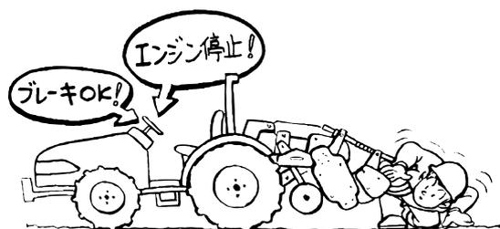
10-2 点検のために外した安全カバーは、必ず元の通りに取付けてください。
