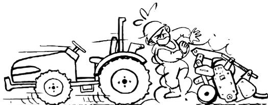
3-3 トラクタと作業機の着脱に際しては、いつでも逃げられる安全な態勢で操作し、このときトラクタは必ずブレーキで止めておいてください。
