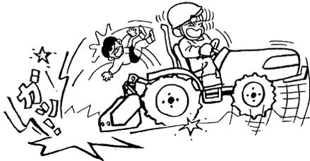
7-3 左右のブレーキペダルを連結して走行してください。
