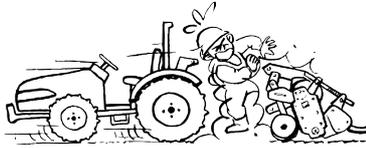
3-3 トラクタと作業機の着脱に際しては、いつでも逃げられる安全な態勢で操作し、このときトラクタは必ずブレーキで止めておいてください。
