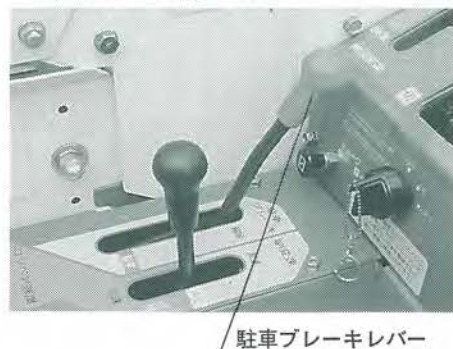
駐車ブレーキが解除される
