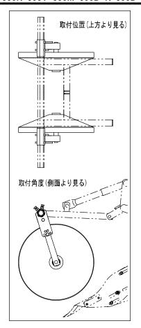
※取付は左右のホイルアームを取外し、ウネオサエホイルを取付ける。 そして各部のボルトを、掘り取り作業をしながら、いもが畝の側方に こぼれ落ちないように調整し、締付けを行う。
