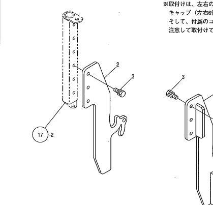
※取付けは、左右のコンテナパイプに付いている半透明のキャップ(左右6個)を外す。 そして、付属のコンテナ台フックL、Rを図の様に左右を注意して取付けてください。(板と溶接している面が外側です)
