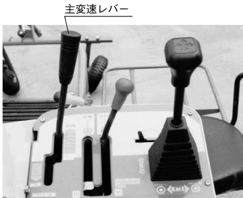
主変速レバーを操作して車速を変えると土の持ち上げ量も変化します。
