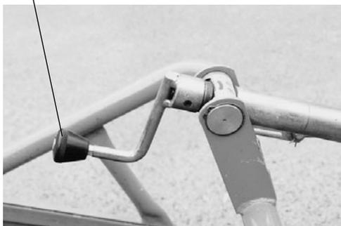
掘取深さを必要以上に深くすると、作物のころがりや土の持ち上げ量の増大で、選別作業が難しくなり、作業抵抗も増大しますので、必要以上深くしないで作業してください。
