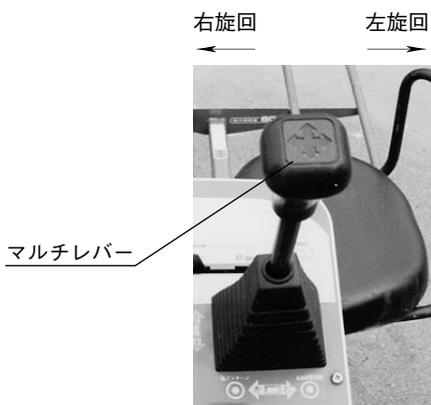
マルチレバーは軽く倒すとクラッチが切れ、それから旋回用ブレーキが効き始めます。強く倒すと、ブレーキを完全にロックすると片側のクローラが逆転してその場旋回（スピントーン）となります。
