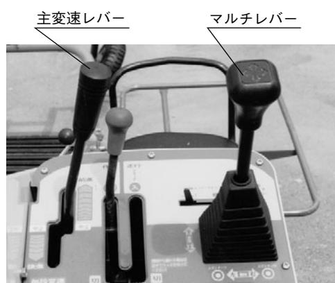
マルチレバーを前方に倒し、コンベア先端をうねに入れていきます。
