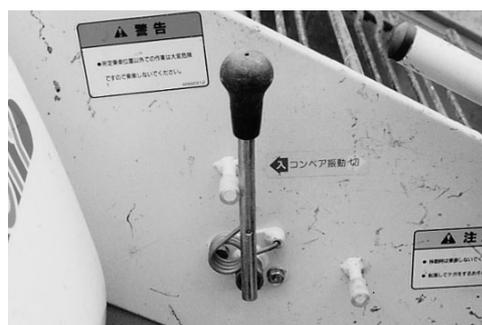
土の上がり量によって、前方、後方の振動を「入」「切」して調節してください。
