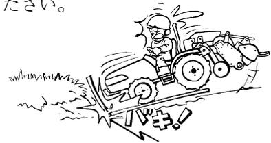
8-3 うねや段差に対して斜め方向に進むと、横滑りや転倒する危険があります。作業機を低くして重心を下げ、直角に進めてください。
