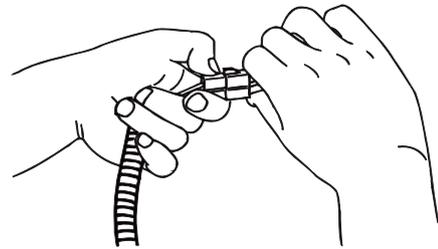
3 バッテリーに取付けられているアース側の（－）側ケーブルをターミナルから取外します。
