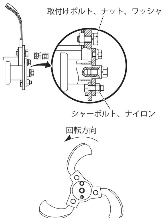
**1** ホルダにツメ（M24R）を差込み、ナットを六角穴に入れ、ボルト、ワッシャで締め付けます。
