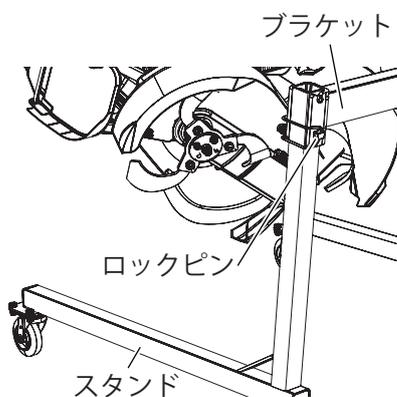
(2) 取外した後は、作業機をゆっくり上下させ、干渉等の確認をします。
