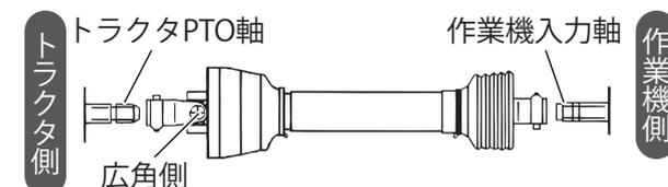
(1) ジョイントのノックピンを押しながら軸に挿入し、軸の溝にノックピンをはめ込み、抜け止めをします。
