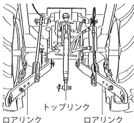
3点リンクの取付け位置は、トップリnk長さやリフトロッド位置を確認し、取付けてください。また、トップリnkの長さも指定の長さに調整してください。
