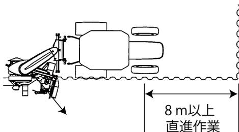
「ガイアマチック」ボタンを押すまでの間の作業は、ガイアマチックの直進精度を大きく左右する大変重要な作業になります。
