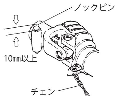
2 ジョイントセーフティカバーのチェンを固定し、回り止めをします。
