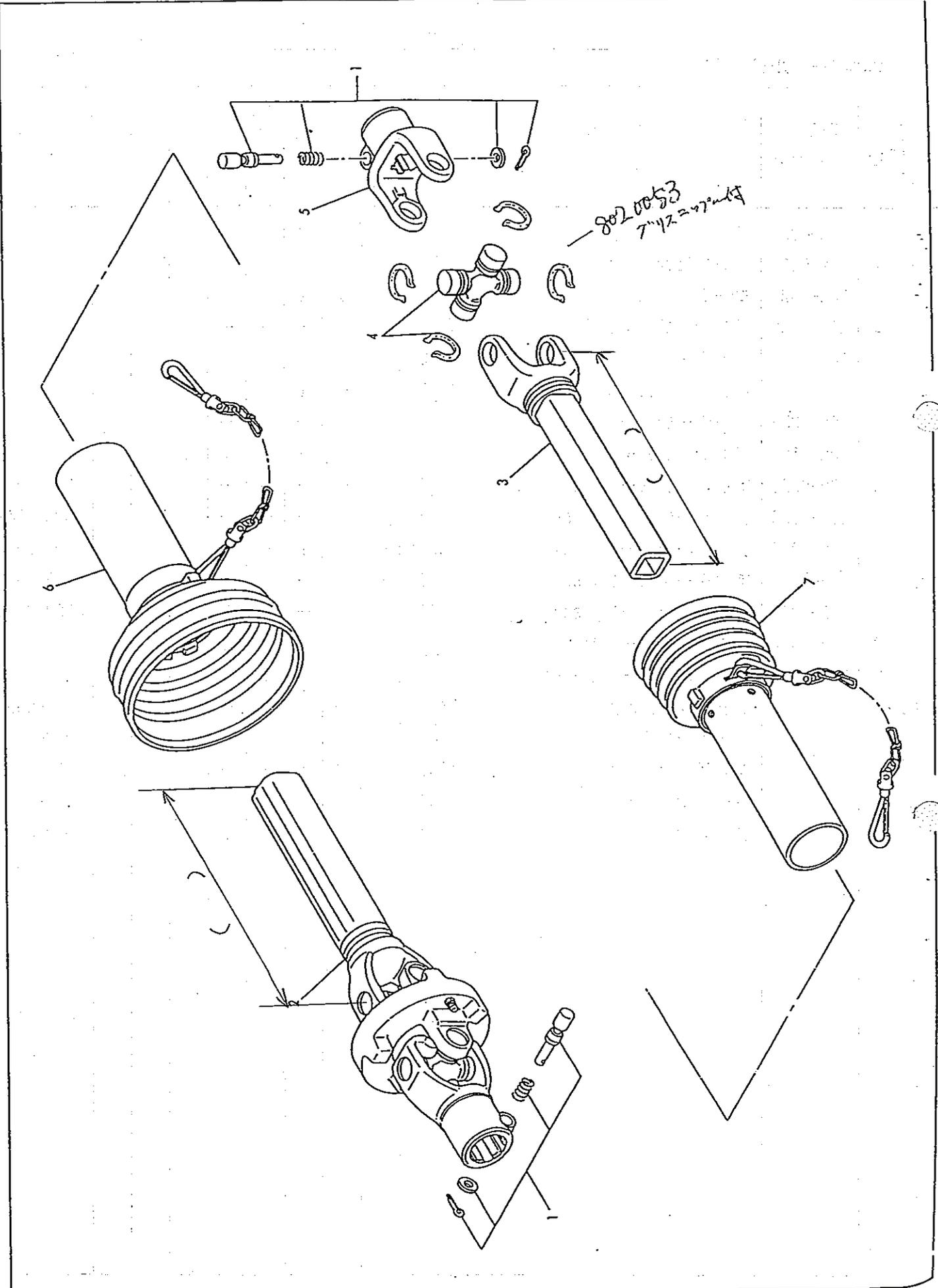
ジョイント (光洋 片広角) KTAC55A,KTAC61A,KTAC65A,KTAC67A,KTAC69A,KTAC72A,KTAC75A
