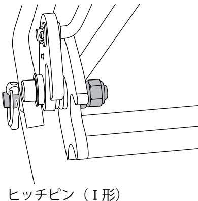
**4** オートヒッチアームをトラクタのトップリンクに取付けます。
