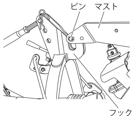
(4) ポジションコントロールレバーを「上げる」にし、フックに合わせて作業機をゆっくりとリフトアップします。
