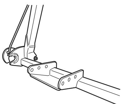
**2 トラクタのポジションコントロールレバーを下げ、ロアリンクをいっぱいまで下げる。**
