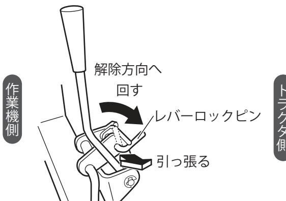
(3) レバーをトラクタ側へ倒します。
