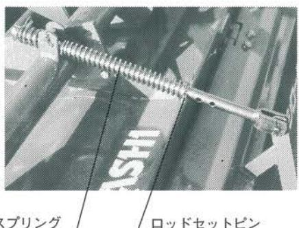
3. 石の多い圃場、湿田、粘土質圃場は、下側ロッドセットピンを抜きバネをフリーにし、写真のようにエプロンを少し上げた状態での作業の方が、土はけが良く所要馬力も少なくなります。
