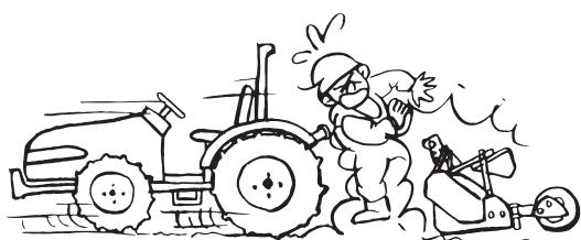
3-3 トラクタと作業機の着脱に際しては、いつもも逃げられる安全な態勢で操作し、このときトラクタは必ずブレーキで止めておいてください。
