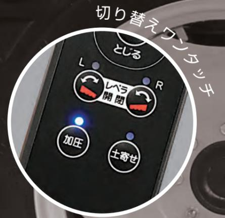
加圧のON、OFFは作業機を持ち上げた状態で加圧スイッチを押すだけで行えます。(代かき作業中には切り替わりません。)
